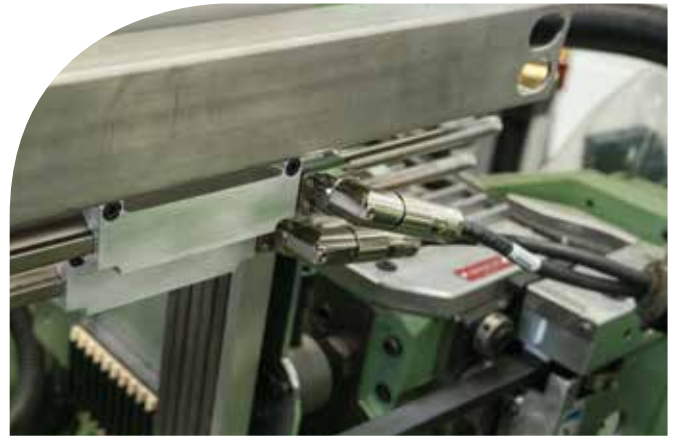
Linearmotoren zur seitlichen Verlegung der zusätzlichen Fadensysteme
