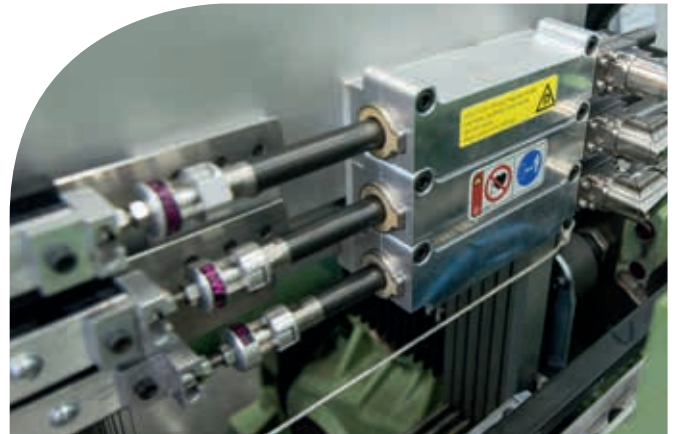
Linearmotoren zum Antrieb der drei Stickachsen (max. Verschiebbarkeit 60 mm)
