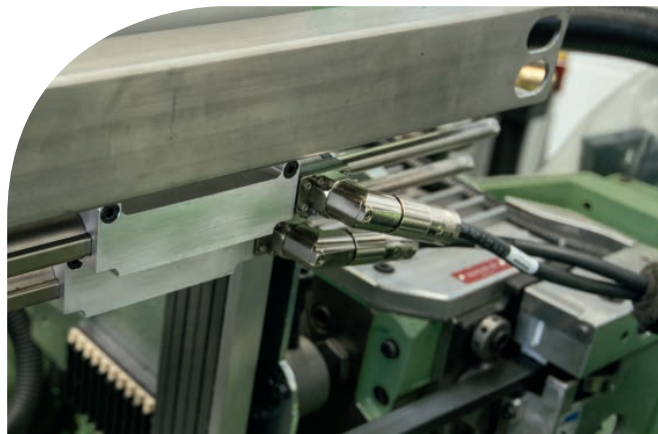
用于控制附加纱线系统侧向位移的线性马达
