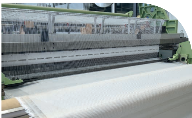
多轴向织物，带有两个附加的纱线系统
