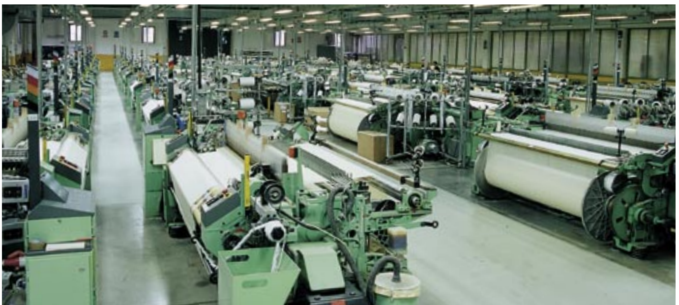
DORNIER-Greifer- und Luftwebmaschinen-Anlage im Werk Varallo, Italien
